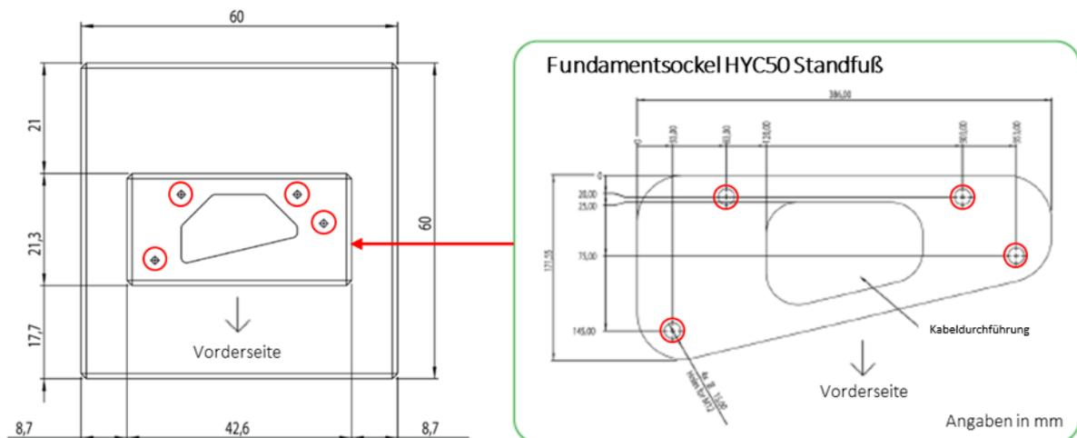
Abbildung 19: Positionierung Standfuß auf Fundament
