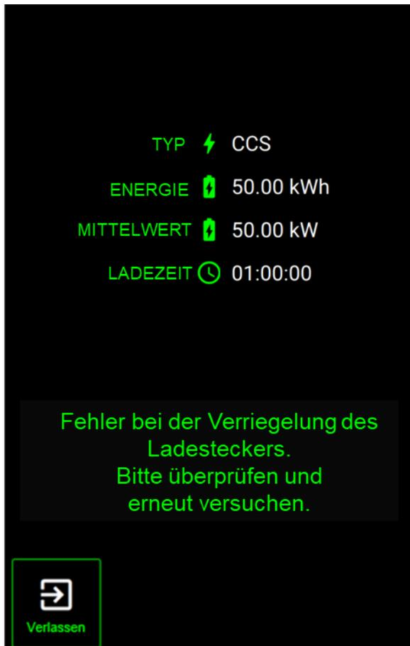
Abbildung 70: Steckerverriegelung fehlgeschlagen
