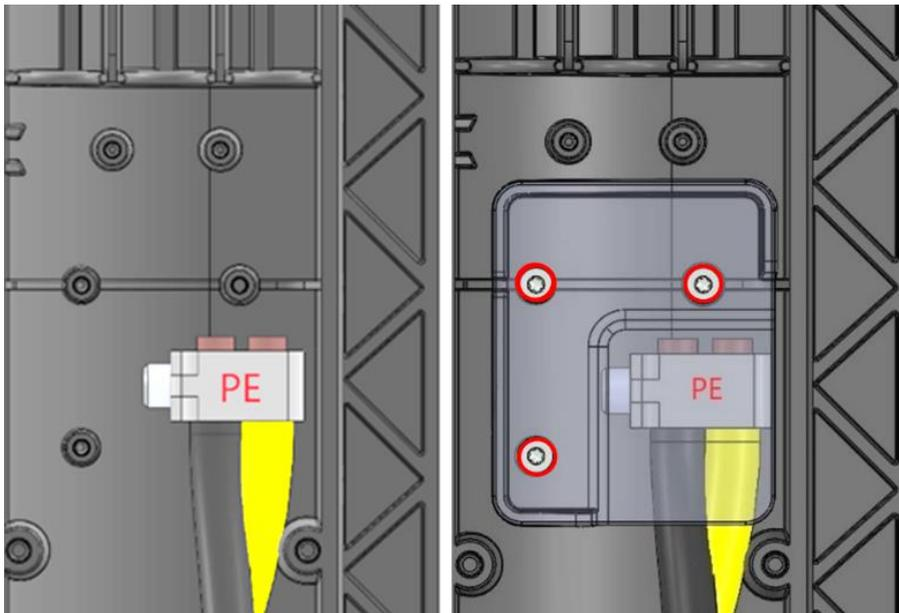
**Abbildung 31:** Montage der Schutzabdeckung über PE-Kabelklemme
