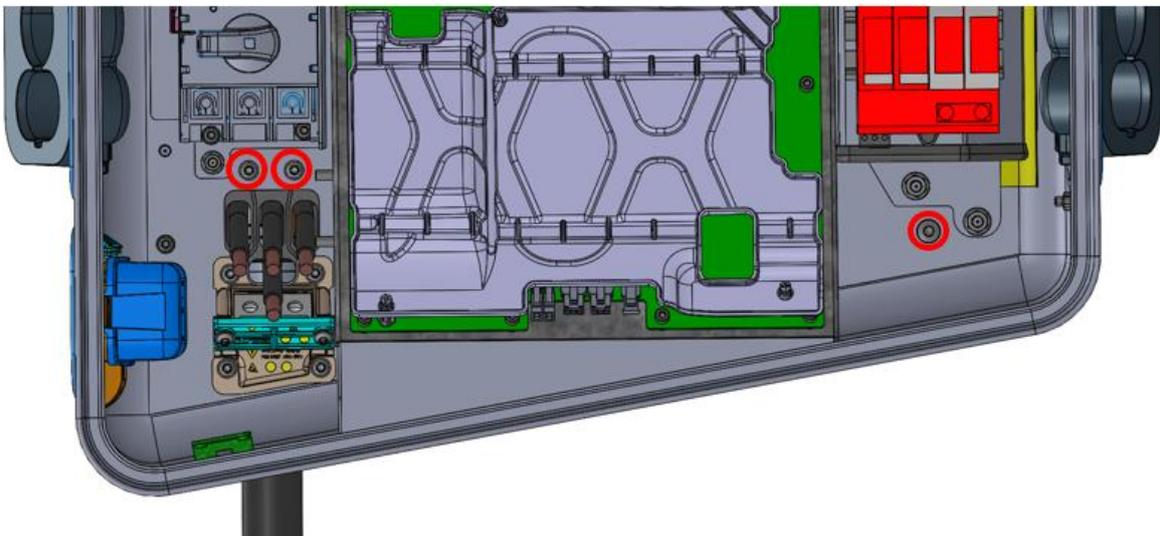
**Abbildung 46:** Erster (rechts) und zweiter (links) Befestigungspunkt
