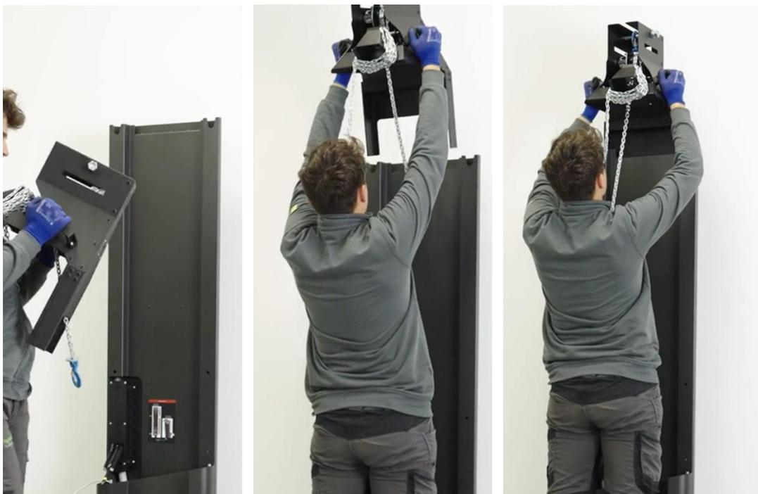
**Abbildung 37:** Montagehilfe einsetzen
