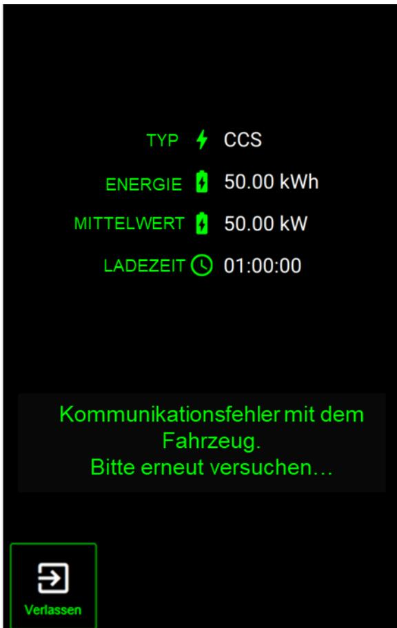
**Abbildung 69:** Fehler beim Kommunikationsaufbau
