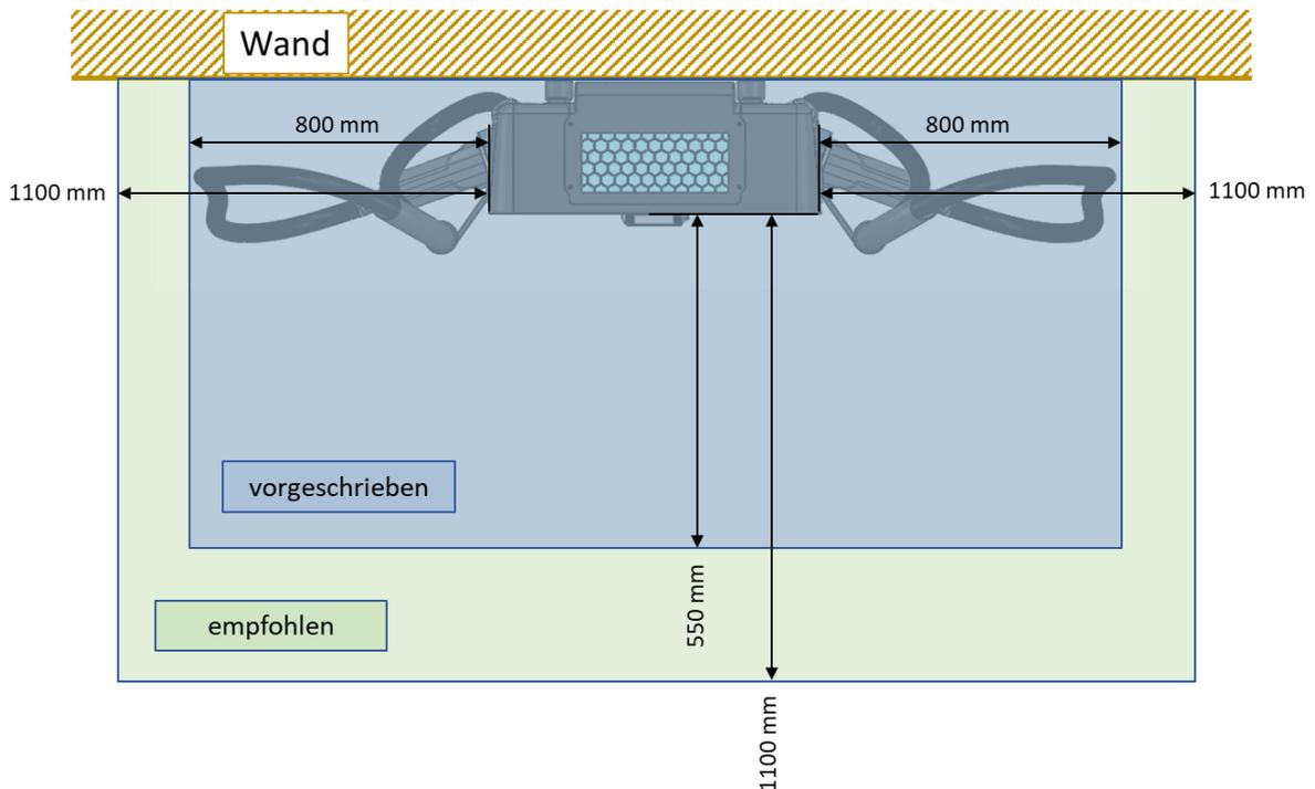
**Abbildung 15:** Empfohlene und vorgeschriebene Mindestabstände bei der Standortauswahl
