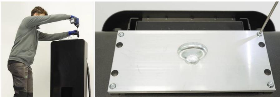
**Abbildung 44:** Adapterplatte entfernen
