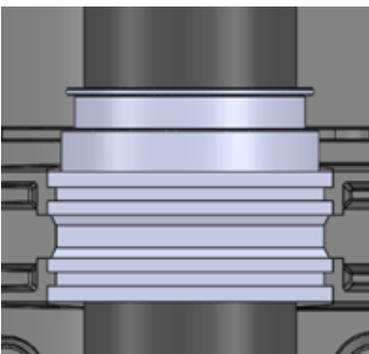
**Abbildung 27:** Netzkabel-Dichtung anbringen
