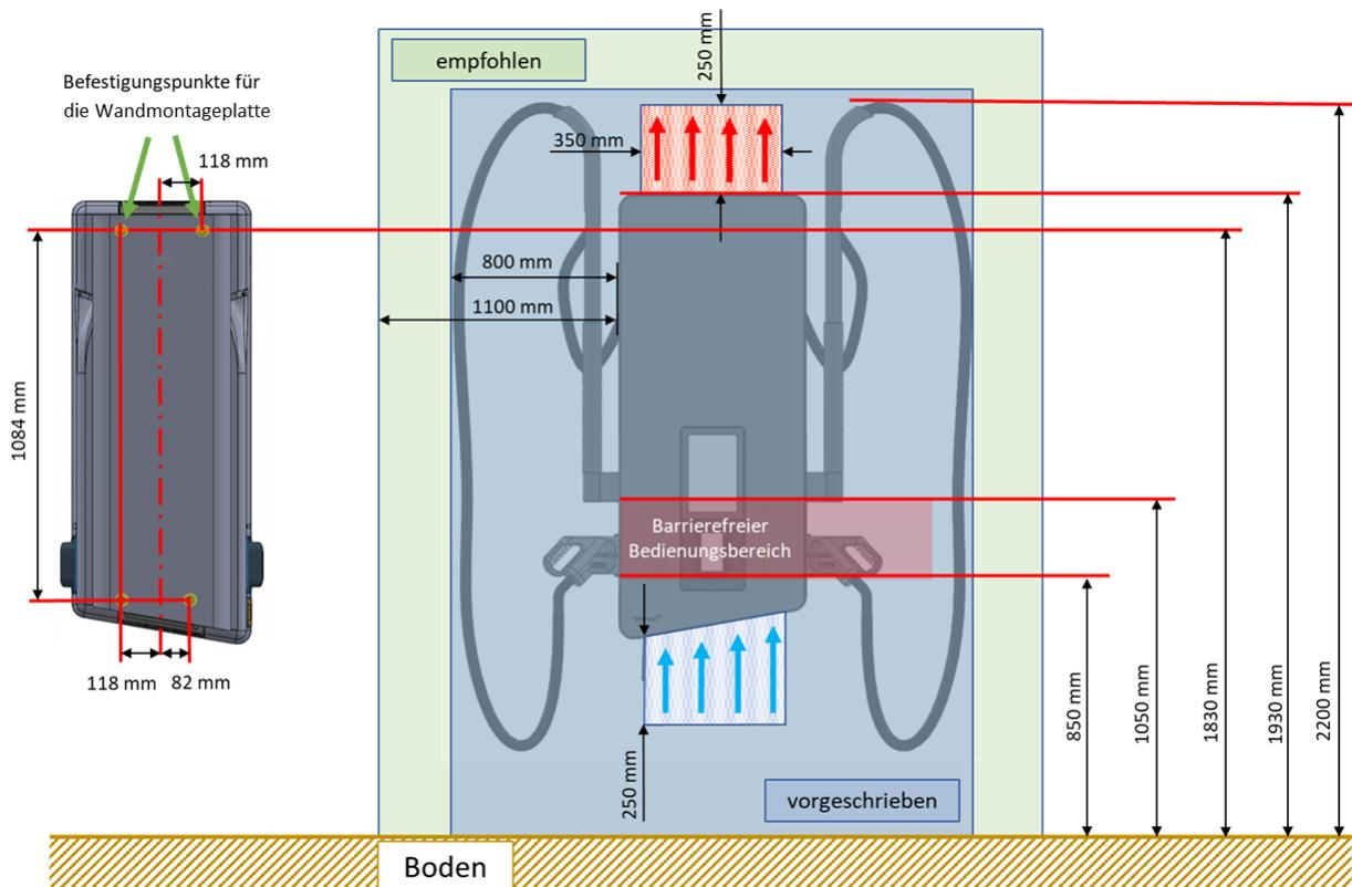
Abbildung 22: Aufstellhöhe (barrierefrei)
