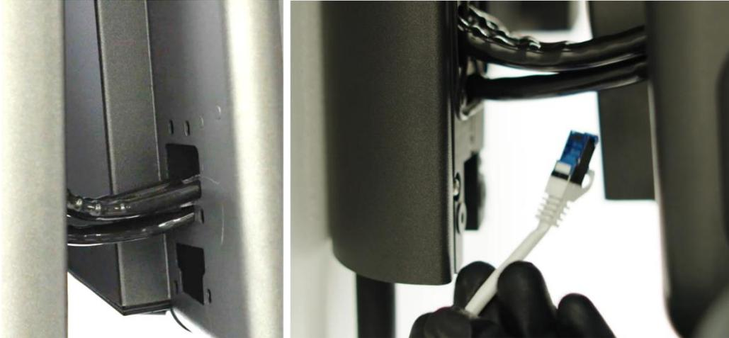
**Abbildung 43:** Anschlusskabel einführen
