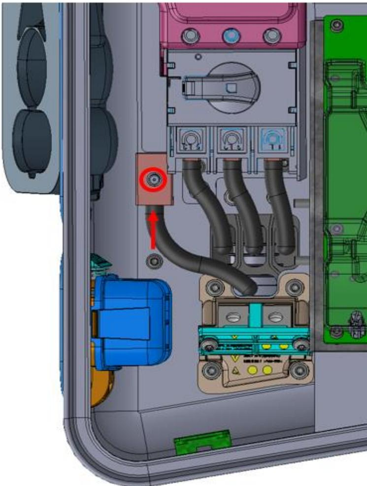
**Abbildung 48:** Schutzleiter befestigen
