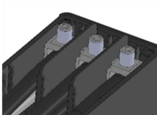
**Abbildung 32:** Phasen mit Kabelfixierung befestigen
